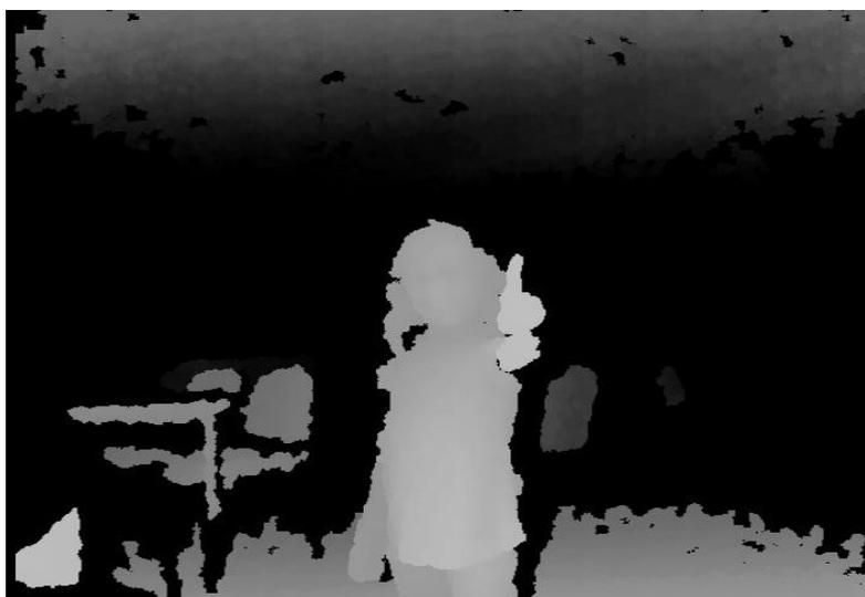
Figura. 1. Mapa de Profundidad obtenido con el Sensor Kinect.
